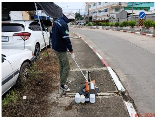
บ่อพักน้ำสุดท้ายก่อนระบายออกจากโครงการ
